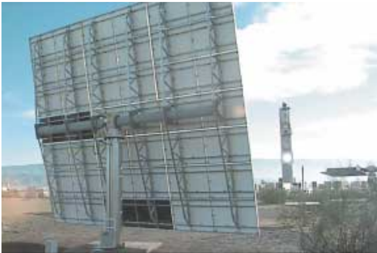
Figura 9. Vista trasera del helióstato COLON-70 instalado en la Plataforma Solar de Almería apuntando al blanco ubicado a una distancia de 380 m y utilizado para su caracterización óptica. En la fotografía se aprecia la estructura en T formada por el pedestal y el brazo soporte. También se aprecian las fijaciones de las facetas a las celosías de la estructura
